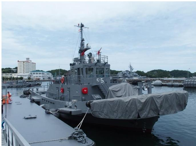
乗船した曳船YT95です。護衛艦の離岸時、接岸時の支援が主な任務です。消防船としての能力も備えています。
